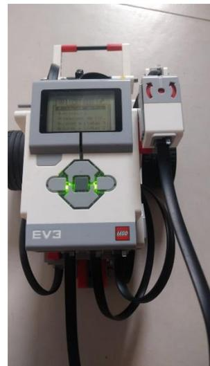
Figura 7: Coloque um fio ligando o giroscópio ao bloco. Lembre-se que o fio é conectado em uma porta numérica (um número)
