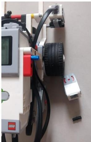
Figura 4: Posteriormente coloque uma peça com três furos para funcionar como expensor
