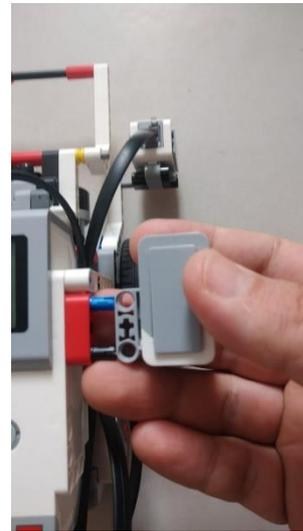
Figura 6: Finalmente encaixe o giroscópio.
